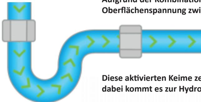
**Aufgrund der Kombination von Warmwasser und unserem System Reiniger sinkt die Oberflächenspannung zwischen Fett und der Rohrwand und aktiviert gleichzeitig die natürlichen Keime im Wasser**
